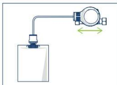
Dopo l'installazione dell'apparecchiatura, a seconda dello spazio utile disponibile, si può decidere di agganciare la ricarica di AcquaSIL 2/15° direttamente al corpo pompa MiniDUE OTTONE (schemi in alto) o in versione remotizzata (schema a sx).
