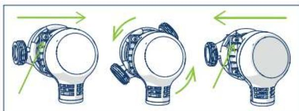
Svitare la vite, ruotare e modificare la direzione di ingresso/uscita dell'acqua
