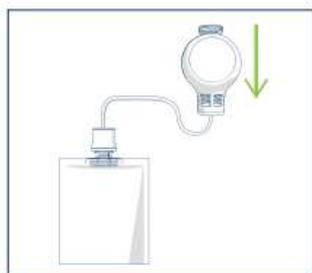
Dopo l'installazione dell'apparecchiatura, a seconda dello spazio utile disponibile, si può decidere di agganciare la ricarica di AcquaSIL 2/15° direttamente al corpo pompa MiniDUE 3/4 (schemi in alto) o in versione remotizzata (schema a sx).
