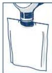
L'assenza di prodotto AcquaSIL 2/15° nella ricarica non viene segnalata da alcun dispositivo automatico, ma è visibile dallo svuotamento/schiacciamento della ricarica stessa.
