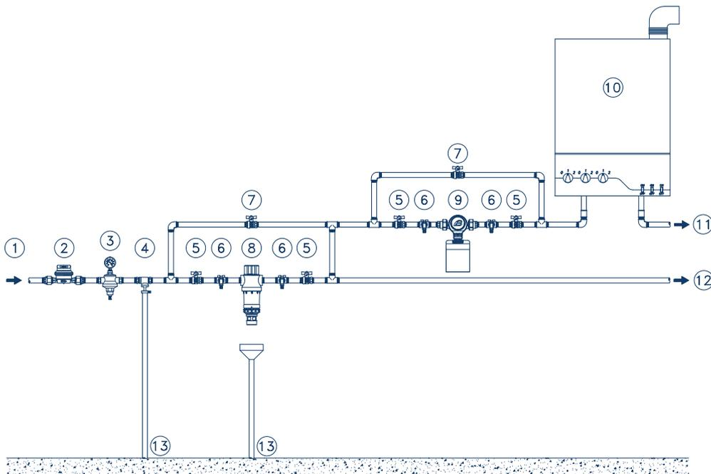
1. Ingresso acqua grezza; 2. Contatore generale; 3. Riduttore di pressione; 4. Disconnettore; 5. Valvola di intercettazione; 6. Rubinetto preleva-campione; 7. Valvola di by-pass; 8. Filtro; 9. Pompa; 10. Caldaia; 11. Uscita acqua calda; 12. Uscita acqua fredda; 13. Scarico.
